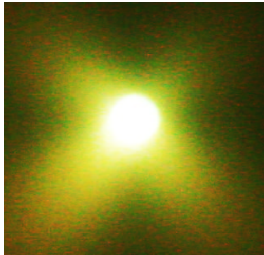
fig. 6.7: Photographie d'une expérience de rétrodiffusion de la lumière blanche par des billes de latex de rayon 1530 nm à la concentration 0,3 %. La lumière incidente est polarisée linéairement et la lumière sortante est observée à travers un polariseur rectiligne dont la direction est orthogonale à la direction de polarisation incidente. On observe un motif en forme de « fleur », à symétrie quatre.
