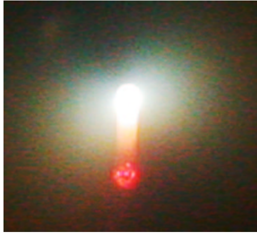
fig. 6.6: Photographie de rétrodiffusion dans le régime de Rayleigh avec une solution à 0,25 % de billes de latex de rayon 138 nm éclairée par de la lumière blanche polarisée linéairement. Le faisceau incident pénètre profondément dans la solution et rougit ce qui est caractéristique de la diffusion de Rayleigh. La lumière qui est rétrodiffusée forme un motif en « papillon » dont l'axe est orthogonal à la direction de polarisation incidente.
